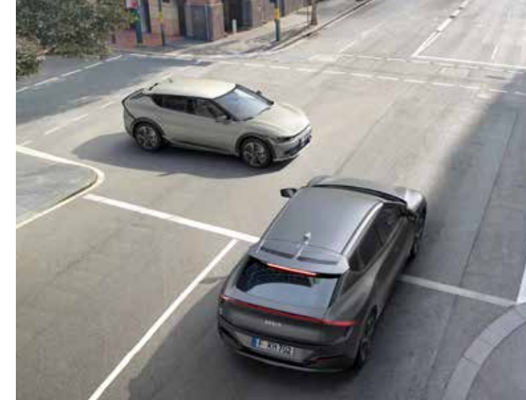
Forward Collision-Avoidance Assist bij afslaan en oversteken (FCA). Via de frontzichtcamera en radar ziet en herkent dit systeem voorliggers, voetgangers en fietsers. Door in geval van nood te waarschuwen en automatisch te remmen, helpt het ongevallen te vermijden of de schade te beperken. In de Kia EV6 werkt dit systeem ook als je een kruising afslaat bij tegemoetkomend verkeer S en optioneel zelfs als je oversteekt M .
